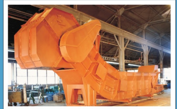
Deslagger Ash Reclaimer
