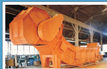
Deslagger Ash Reclaimer
